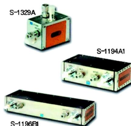
Fig. 1 市販されている放射光用イオンチェンバー。信号、高圧印加用コネクタとガス出入口が見える。窓にはカプトンが貼られている。
