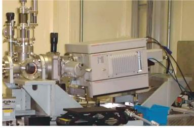
Fig. 2 SPring-8 BL19LXU に設置された X 線ストリークカメラ。
