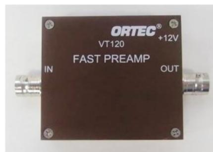
Fig. 8 (左)タイミング計測用アンプ。(右) ORTEC VT120。
